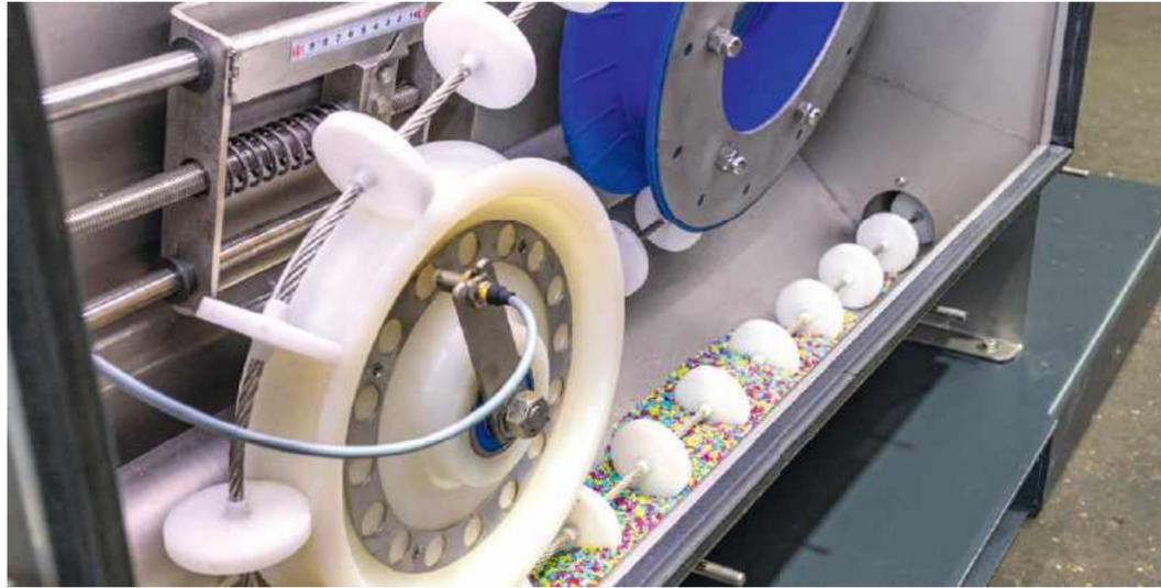
Antriebsstation mit Friktionsrad und einer integrierten Spannvorrichtung.
